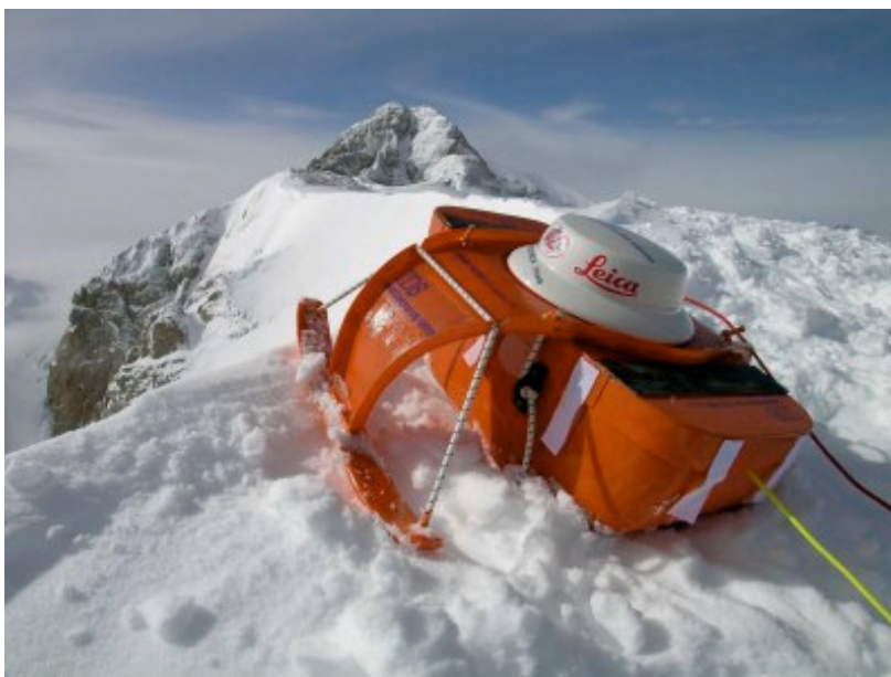
Fig. 4 - Aprile 2004. Il primo prototipo di georadar della IDS con GPS abbinato.
