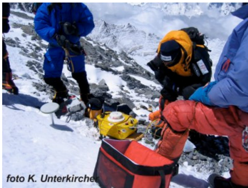
Fig. 6 - La fase iniziale di avviamento del GPS-master (fisso) e del georadar/GPS (mobile), in corrispondenza degli affioramenti rocciosi sul pendio Sud sotto la vetta del Monte Everest.
